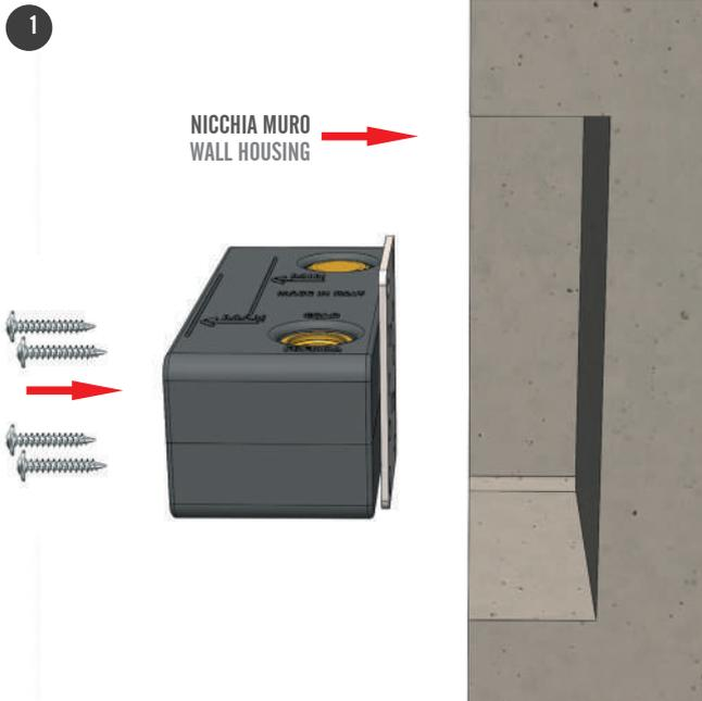
Creare una nicchia nel muro in modo tale che, una volta fissato il box incasso al suo interno, il bordo del muro finito e piastrellato sia compreso tra le due linee in rilievo (min. & max.) stampate sul box incasso.
