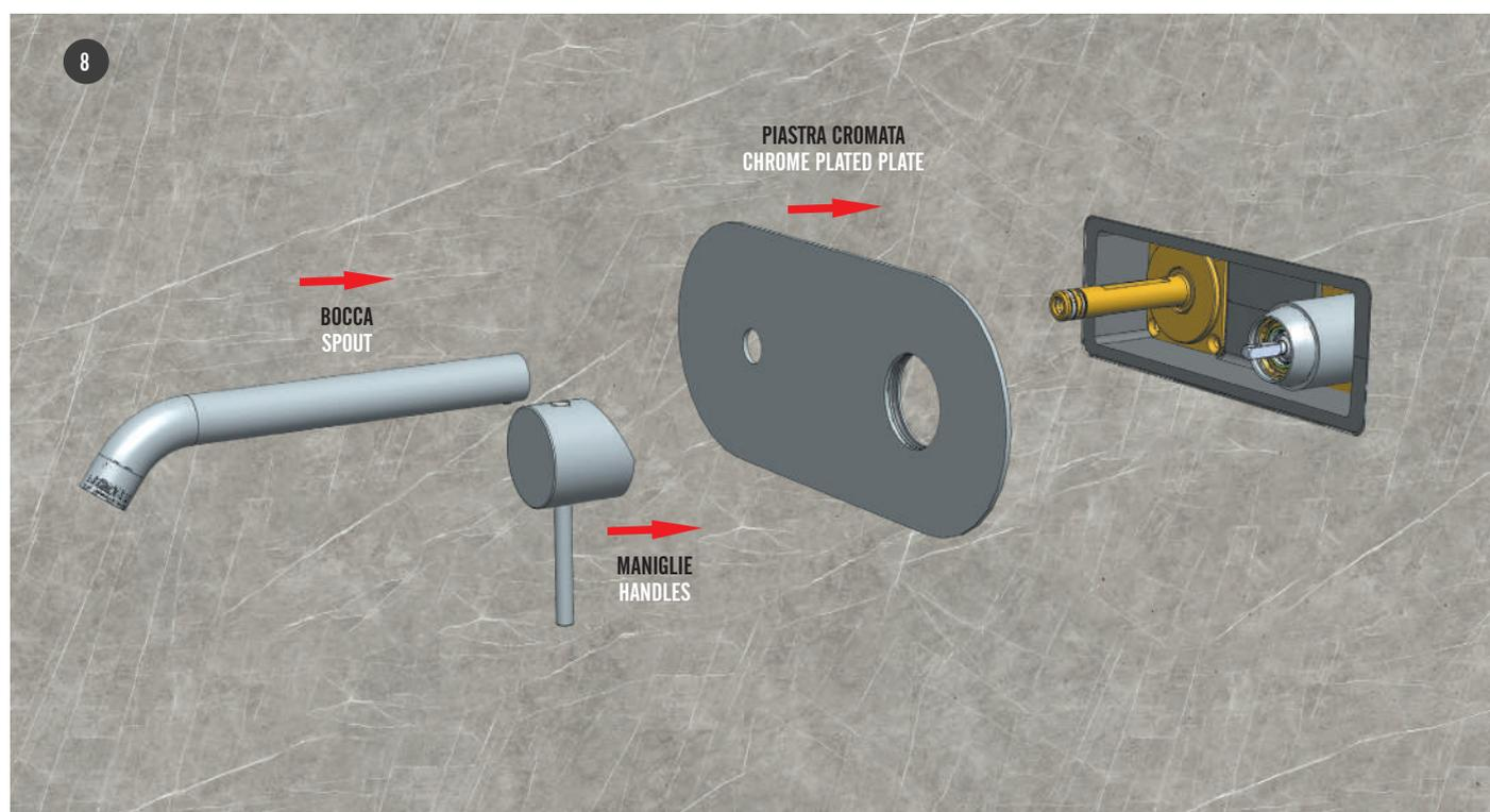
Montare la piastra cromata, la maniglia e la bocca per completare l'installazione.
