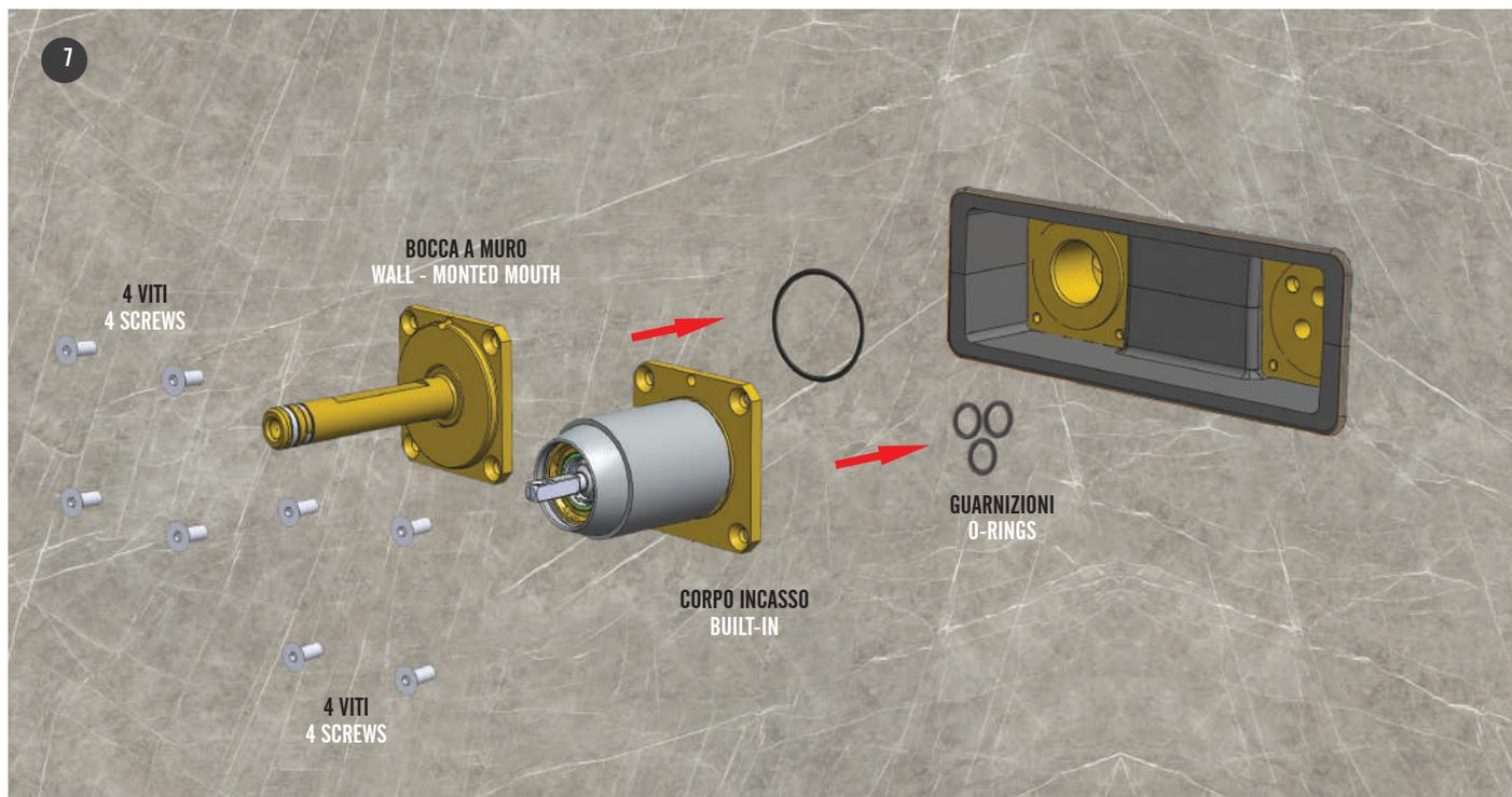
Montare il corpo incasso e il supporto bocca all'interno del box aiutandosi per il corretto assemblaggio del miscelatore con la spina di centraggio in dotazione. Durante questa fase assicurarsi di aver inserito le piccole guarnizioni indispensabili per la tenuta ermetica nei passaggi acqua.
