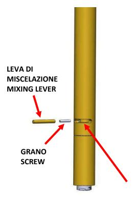
**5)** AVVITARE IL GRANO NEL FORO FILETTATO DELLA CARTUCCIA E LA LEVA DI MISCELAZIONE SUL GRANO SCREW THE SCREW IN THE CARTRIDGE THREADED HOLE AND THE MIXING LEVER ON THE SCREW
