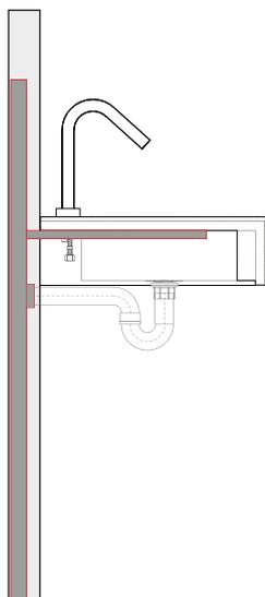
Крепление к стене при помощи специальной несущей конструкции для подвесных установок на гипсокартон.\*
