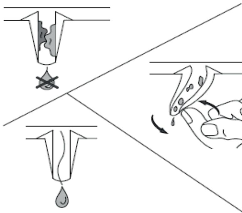
**IT** - Gli ugelli del soffione, realizzati in silicone, vanno ripuliti dai sedimenti (calcare) con l'ausilio delle dita. Sarà sufficiente eseguire piccoli movimenti rotatori sull'ugello otturato per liberarlo da ogni ostruzione. In caso di utilizzo costante della doccia, si consiglia una pulizia approfondita mensile.
